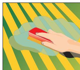
Das Polyacryltuch ist imprägniert. Pflegen Sie das Tuch bei Bedarf wie folgt: Kleine Verunreinigungen können mit einem farblosen Radiergummi entfernt oder trocken ausgebürstet werden. Das Tuch (Polyacryl und PVC) kann bei leichter Beschmutzung mit verdünnter Seifenlösung (5 %, ca. 30°C) und einer weichen Bürste abgewaschen werden. Danach mit klarem Wasser gründlich nachspülen. Eventuell den Vorgang wiederholen. Die Markise erst wieder einfahren, wenn das Tuch vollkommen trocken ist.
